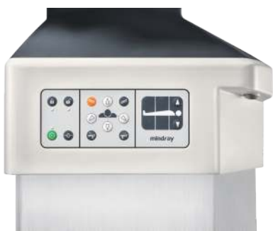
Резервная панель управления
